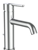
Umyvadlová stojánková páková baterie s výtokem 135 mm, kartuša Eco+, prietok 5,7 l/min, chróm, s automatickým výpustom
